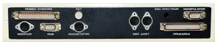
Parte trasera de un Elwro 800 Junior con sus distintos conectores
