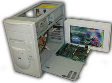
Clon Sprinter con caja y montado en carcasa minitorre
