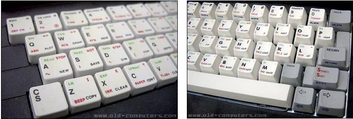
Comparación entre el teclado de 40 elementos del HC91 (izquierda) y el de 50 elementos (derecha)
