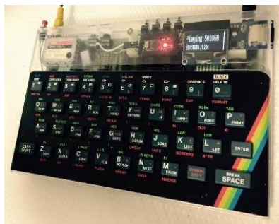
Arriba: TZXduino. Derecha: TZXduino insertado en un Spectrum 48K por Davide Barlotti.
