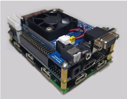
Configuración completa del MiSTer con placas secundarias y ventilador de refrigeración
