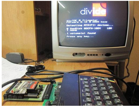
El Arlequín revisado y montado por J. L. Novellón Martínez reconoce un DivIDE y su tarjeta CF (test 2012)
